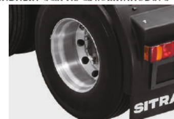
Ступица колеса из алюминиевого сплава
