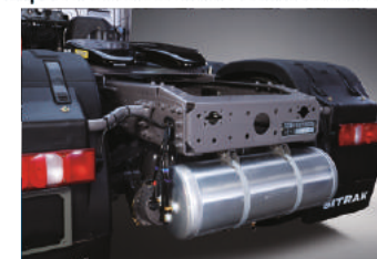
Воздушный резервуар из алюминиевого сплава
