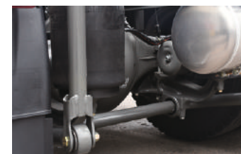
Пневматическая подвеска с четырьмя пневмобаллонами
